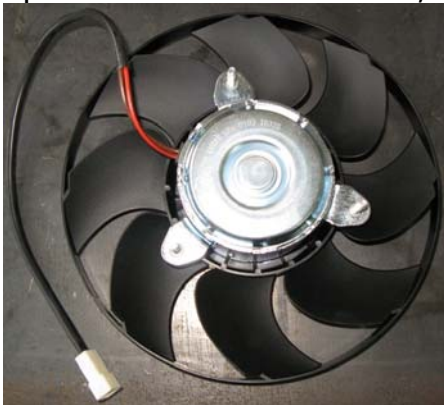
Фото 3. Вентилятор «LUZAR». Гарантийный срок – 2 года. Крыльчатка 8-ми лопастная, спрофилированная.
