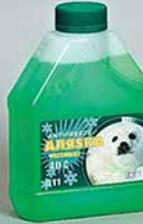
Применен запрещенный метанол. Не соответствуют стандарту: плотность, температура начала кристаллизации ( $-37^{\circ}\text{C}$ ), фракционный состав, коррозионное воздействие. Использовать опасно.
